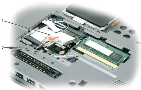
1 WLAN 卡 2 金属固定夹 (2)
