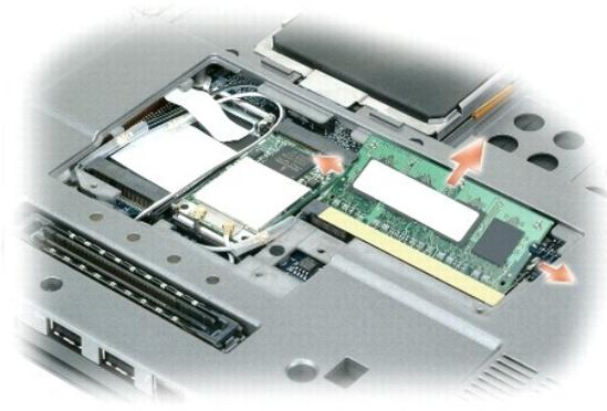
**注：**为了获得最佳性能，应在每个连接器中使用相同的内存模块。
