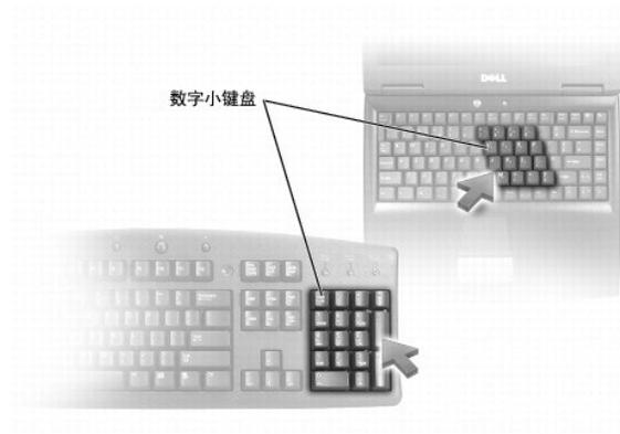
数字小键盘的功能类似于外部键盘上的数字小键盘。小键盘上的每个按键均有多种功能。小键盘上的数字和符号以蓝色标记，位于小键盘按键的右侧。要键入数字或符号，请按住 <Fn> 键并按所需按键。
