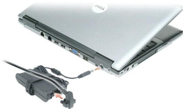
交流适配器将交流电源转换为计算机所需的直流电源。无论计算机处于打开或关闭状态，您均可以连接交流适配器。
