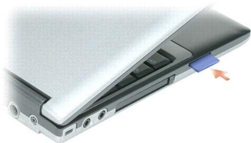
要卸下安全数字卡，请向内按压插卡，它将向外弹出。从计算机中取出插卡。
